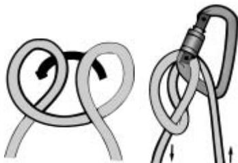
Anwendung: Der Knoten wird als ausschließlicher Sicherungsknoten eingesetzt. Kein anderer Knoten ist zulässig; wohl aber andere Geräte, welche für die Partnersicherung zugelassen sind.
