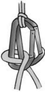
Anwendung: Der Knoten dient als Rücklaufsperrung beim Seilspannen in Konstruktionen; meist in Verbindung mit einem Flaschenzug.
